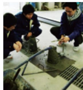
週2回の活動では、作ったコンクリートの塊を砕き、石や砂状にして、再び成型し、その強度を試験し、データを取り、再び破壊するという工程を延々と続けます。成型時の配合率は毎回変えていて、強度の変化を見ます。作業の時に砂や石を仕分けるスペースは、部員たちの自作。
